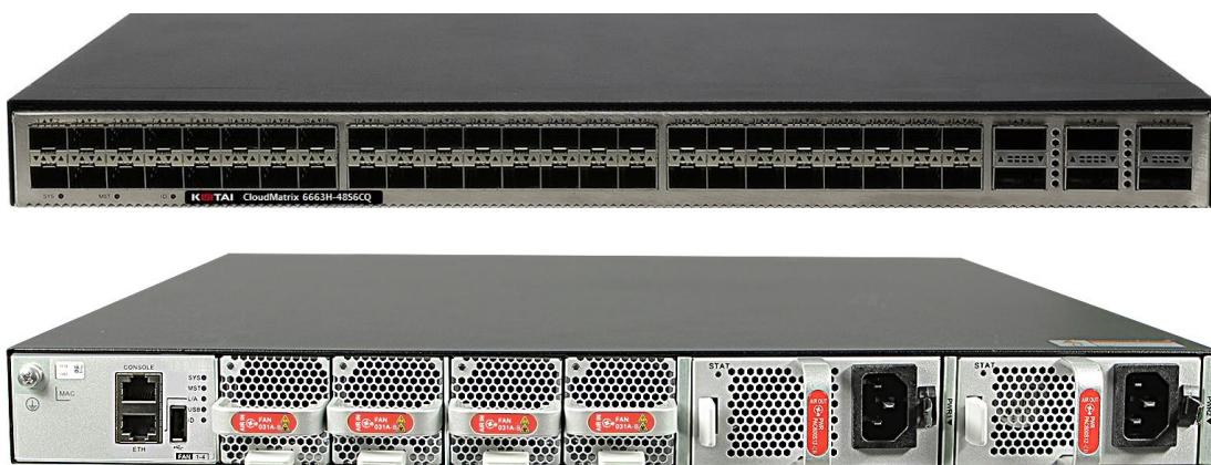
CloudMatrix 6663H系列交换机是神州鲲泰面向数据中心推出的新一代高密度的 25GE 接入交换机，支持 100GE 上行端口，软件平台基于新一代的操作系统。
